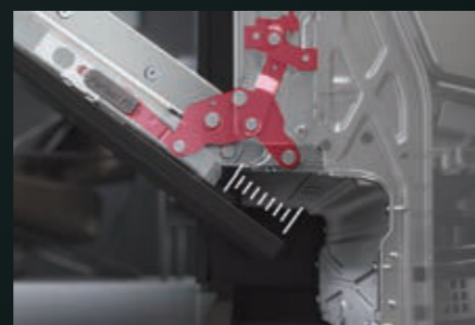
Alignement absolu (jusqu'à 5 mm d'ajustement)
