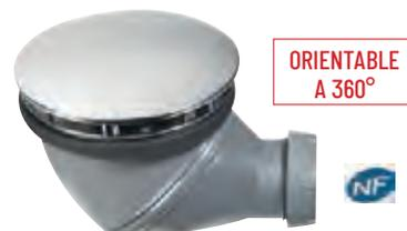
Bonde de douche multiposition Ø 90, avec dôme en ABS chromé. Encombrement sous receveur 83 mm en montage horizontal et 123 mm en vertical. Garde d'eau 50mm. Débit 31L/mn en pos.horizontale et 34,5l/mn en pos.verticale.
