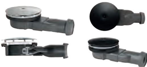
Bonde de douche slim extra plate Ø 90, encombrement de 40 mm sous receveur, dôme en ABS, membrane en silicone amovible pour faciliter le nettoyage. Sortie Ø 40 mm à visser ou à coller. Débit : 33,6l/mn
