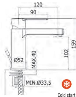
Cartouche ECO-ENERGIE, aérateur à réducteur de débit, économiseur d'énergie par jet d'eau froide même en position centrale de la poignée, l'eau chaude coule uniquement en position totale à gauche.
