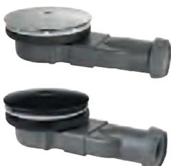
Bonde de douche extra plate Ø 90, encombrement de 40 mm sous receveur, capot en ABS, membrane en silicone amovible pour faciliter le nettoyage.
