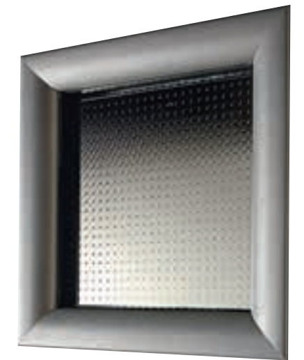
Hublot Réf. 11, cadre aluminium RAL 9006, double vitrage feuilleté clair extérieur Securit Master carré intérieur.
